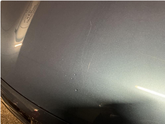
1.1 Ripe(r) ned til grunning
