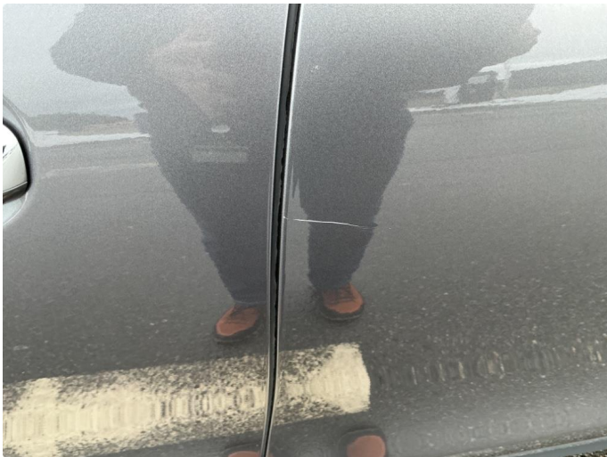
1.1 Ripe ned til grunning
