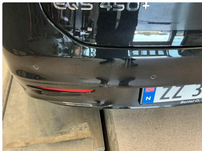
1.3 Ripe(r) ned til grunning
