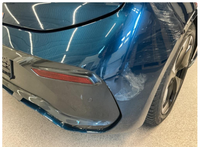
1.3 Ripe(r) ned til grunning
