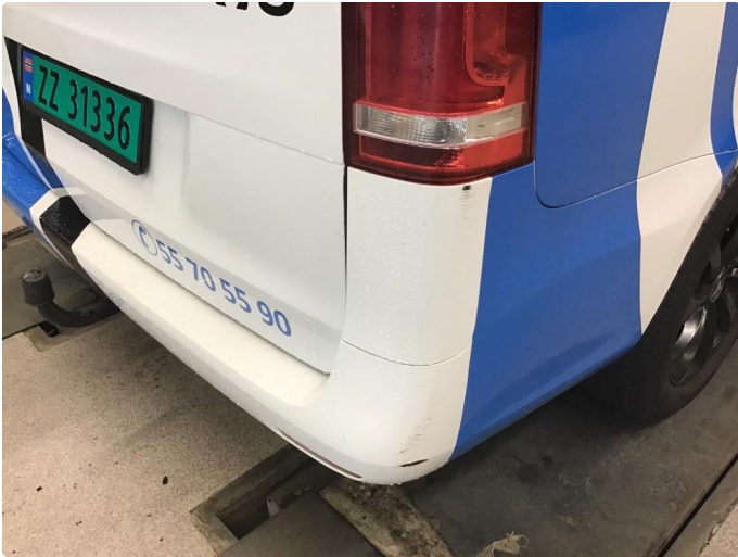
1.2 Ripe(r) ned til grunning
