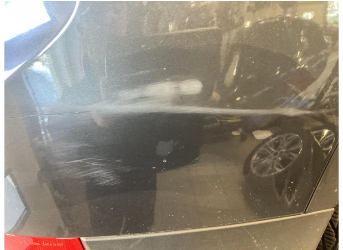
1.3 Ripe(r) ned til grunning
