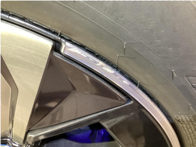
1.1 Kantkjørt felg Diamond Cut
