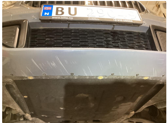
1.1 Ripe(r) ned til grunning
