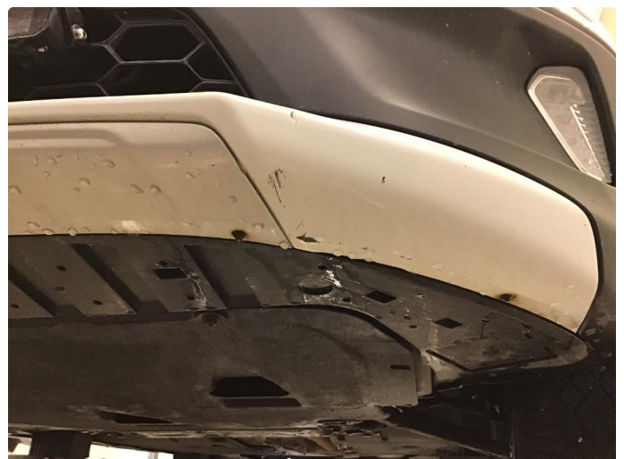
1.5 Noen skrubbeskader under støtfanger foran.
