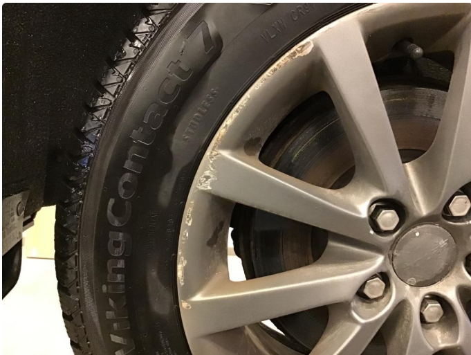
1.1 Kantkjørt felg høyre foran.
