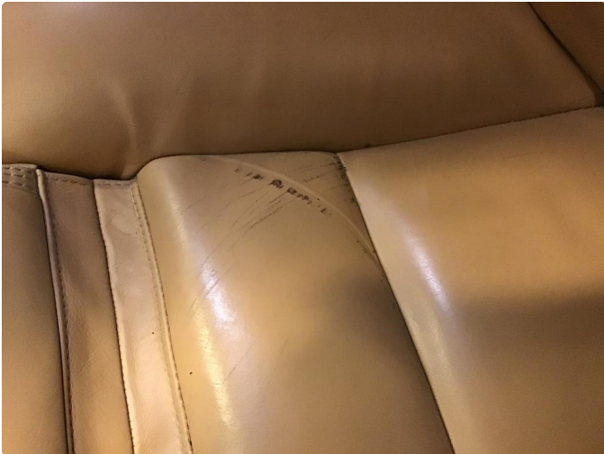
1.1 Skader på sitteputetrekk førersete.
