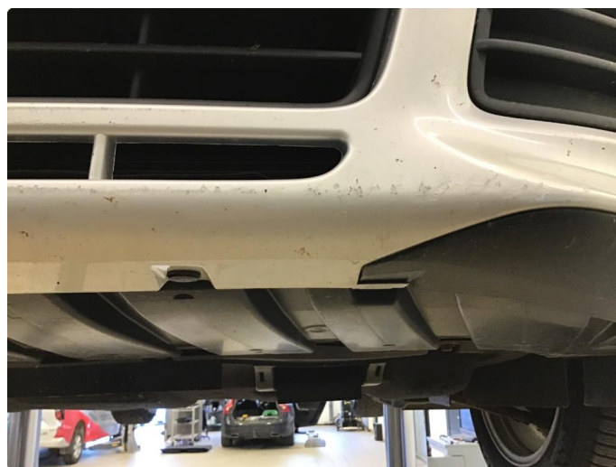
1.4 Noe skrubbskader underkant
