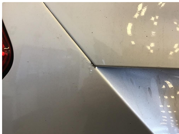
1.2 Rustdannelse på bakluke.
