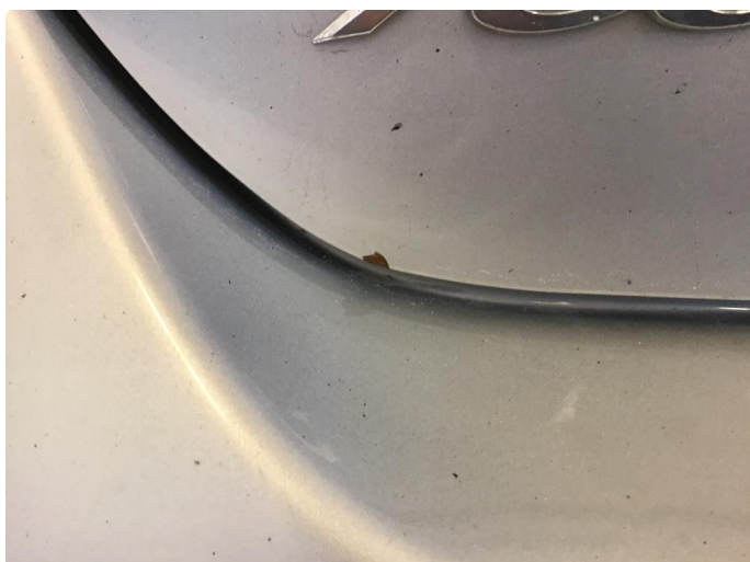
1.2 Rustdannelse på bakluke.
