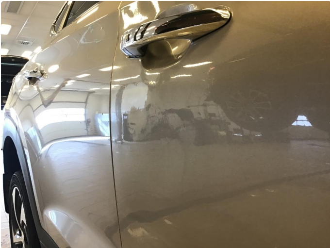
1.1 Flere småbulker på høyre framdør.
