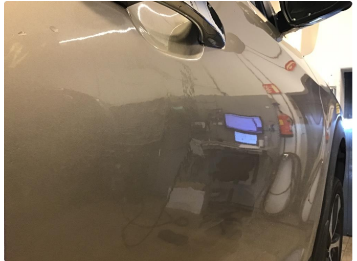
1.1 Flere småbulker på høyre framdør.
