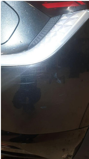
1.1 Ripe(r) ned til grunning
