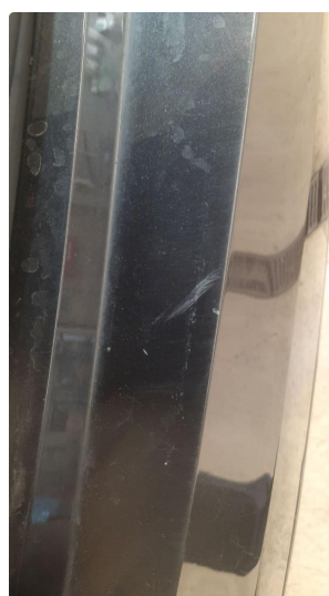
1.4 Ripe(r) ned til grunning
