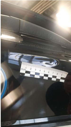
1.1 Bulk med lakkskade halv del
