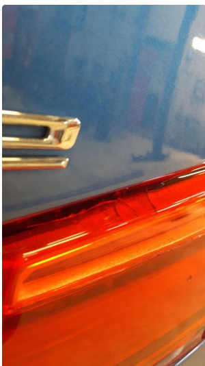
2.1 Defekt / sprukket glass
