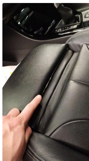
2.1 Skade på setetrekk
