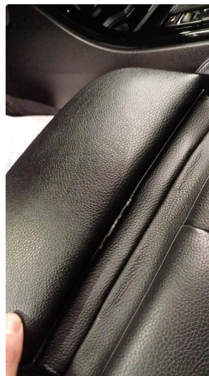
2.1 Skade på setetrekk
