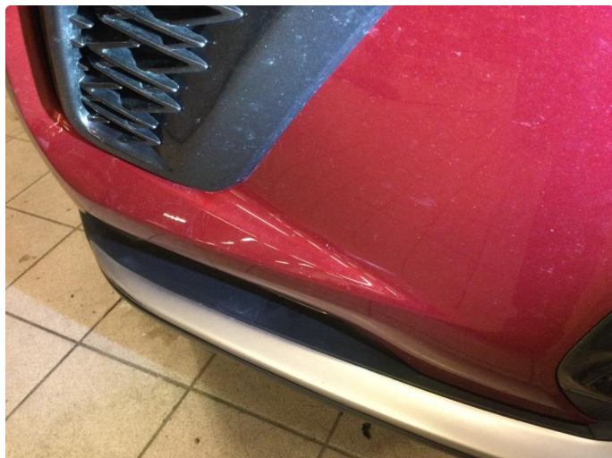
1.1 Noen riper og småbulker
