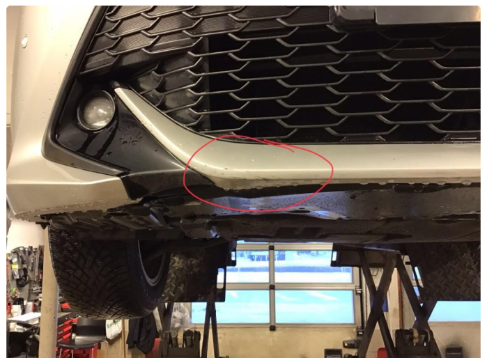
1.4 Ripe(r) ned til grunning
