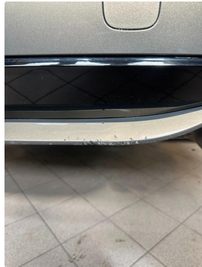
1.1 Merker i lakken støtfanger bak
