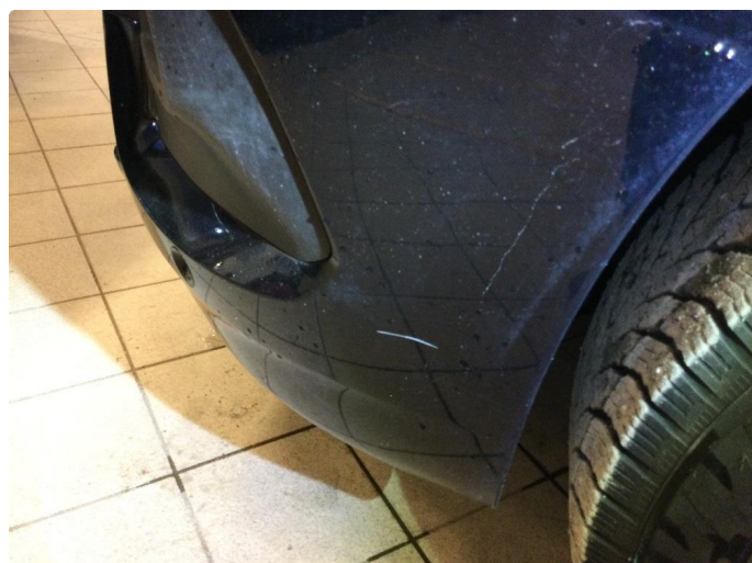
1.1 Noen riper og småbulker
