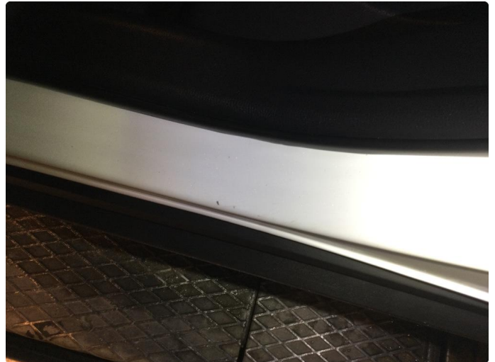
1.1 Noen riper og småbulker
