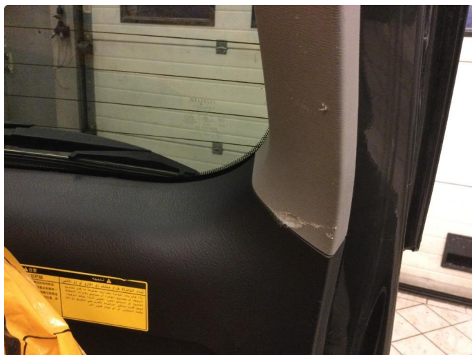
4.1 Skadet/merker etter utstyr
