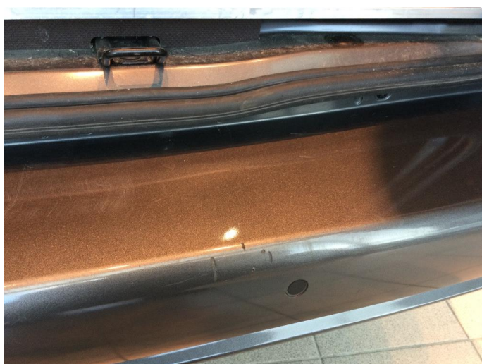
1.1 Bulk med lakkskade
