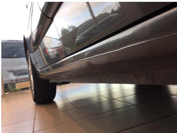
1.1 Bulk med lakkskade
