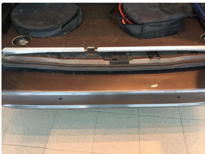
1.1 Bulk med lakkskade
