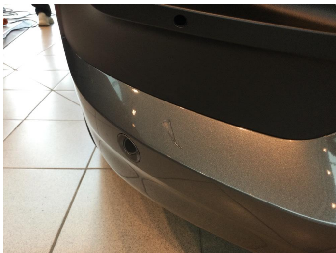
1.1 Bulk med lakkskade
