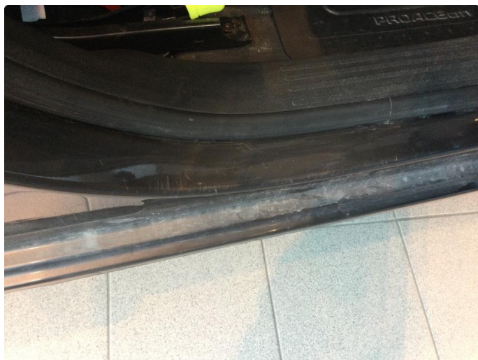
1.1 Bulk med lakkskade
