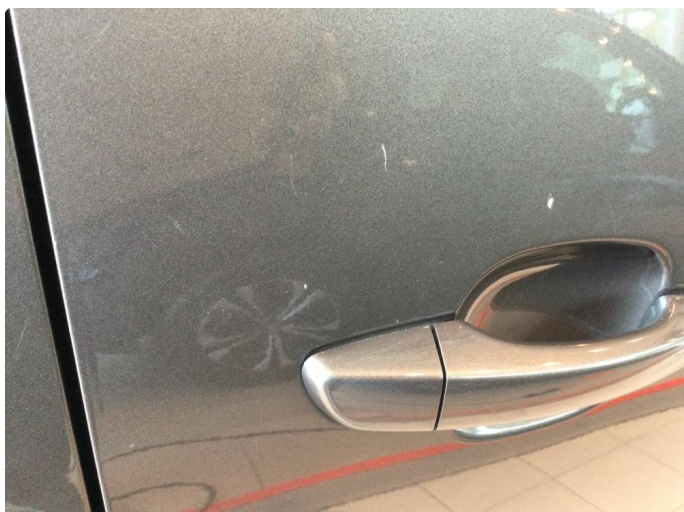
1.1 Bulk med lakkskade
