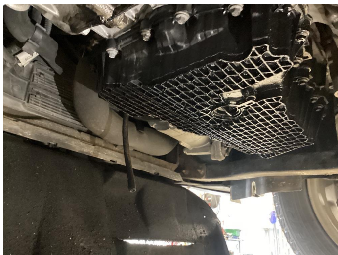
4.1 Oljelekkasje mellom motor/gear
