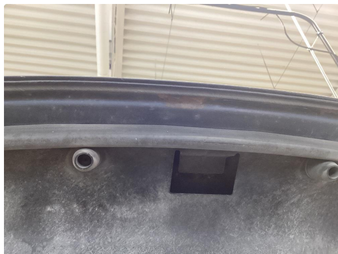
2.1 Rust i fals
