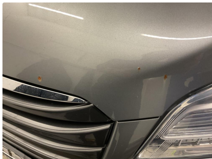
2.1 Noe steinsprut med rust
