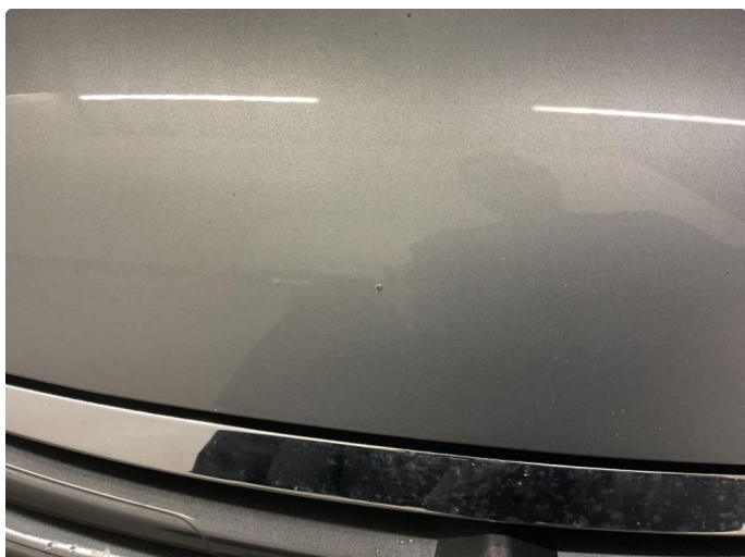
2.1 Noe steinsprut med rust
