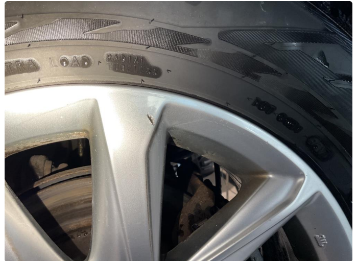
1.2 Skade på felg, normal slitasje
