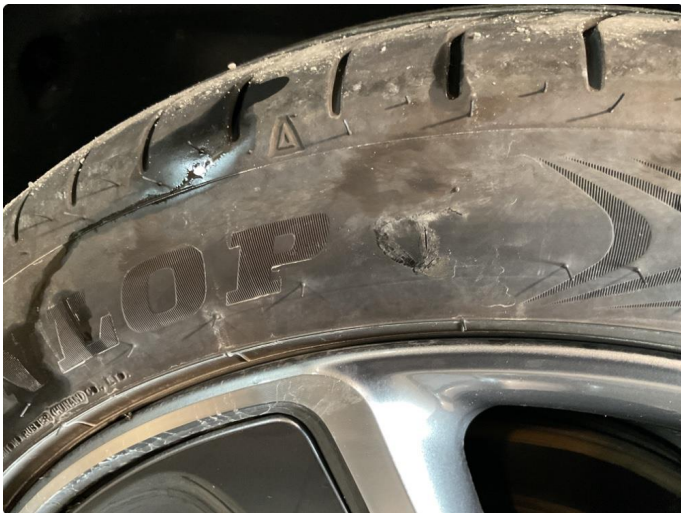
1.2 Skade på dekkvegg venstre bak "Flipp" ser ut til å være limt.
