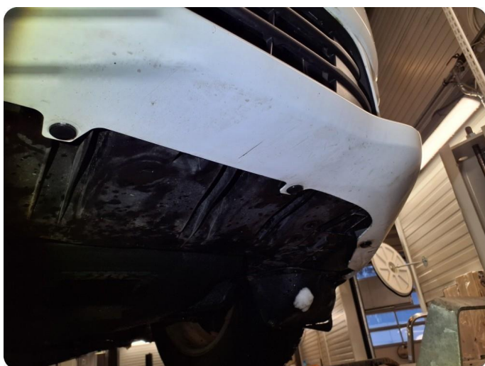
1.3 Noe sår/riper under støtfanger foran.
