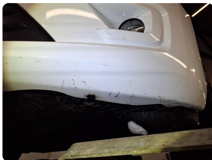
1.3 Noe sår/riper under støtfanger foran.
