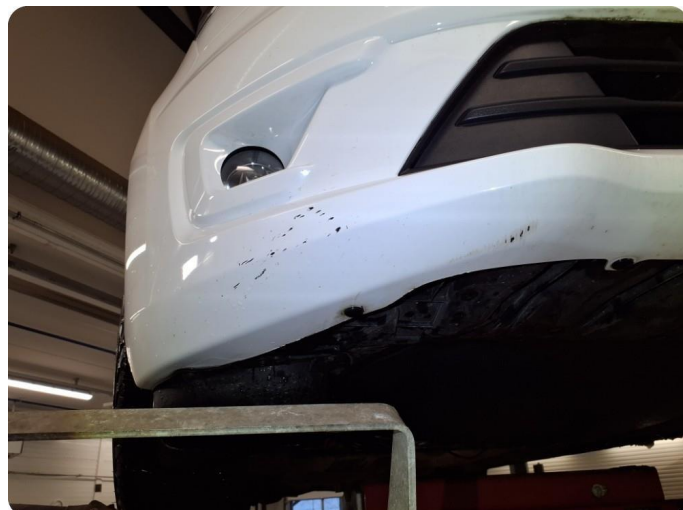
1.3 Noe sår/riper under støtfanger foran.
