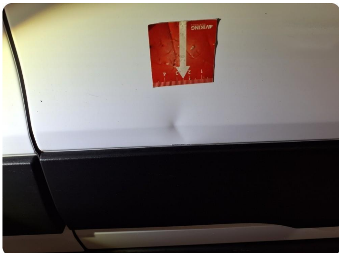
1.1 Mindre parkerings bulk, vanskelig å avbilde.
