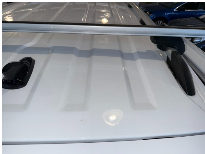
2.5 Parkerings bulker og sår/slitasje.
