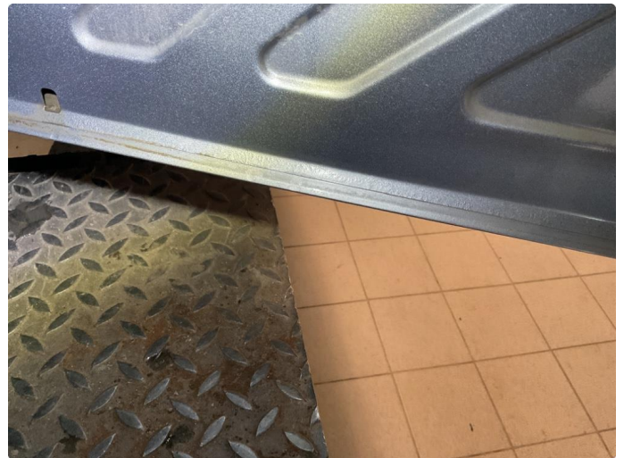
1.3 Noe fugerust i passasjerør V/F
