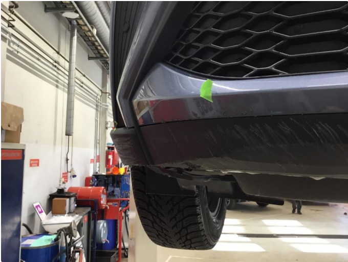
1.1 Noe riper nedre del fanger foran. (Normal Bruksslitasje)
