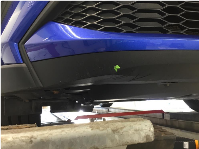
1.2 Noe subberiper i nedkant på svart plast fanger foran. Normal bruksslitasje.
