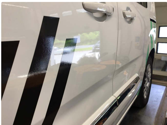
1.1 Liten p-bulk venstre fordør. Normal bruksslitasje.
