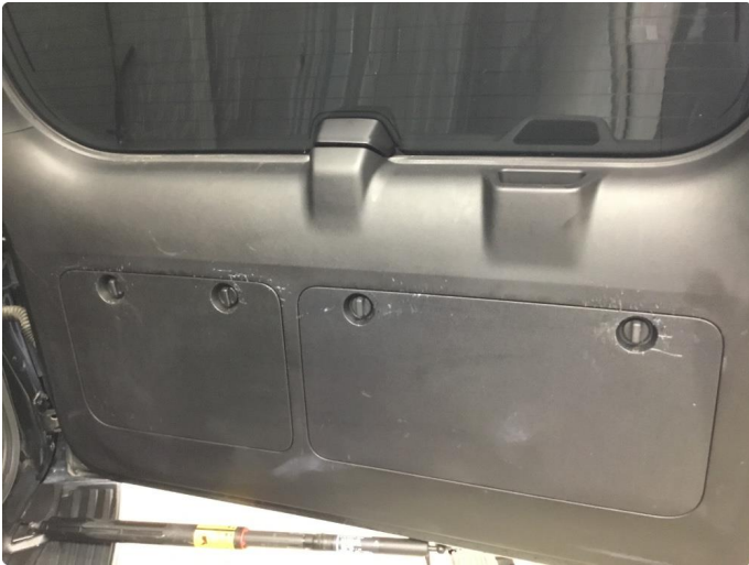
1.1 Noe riper/bruksslitasje dørtrekk v.bakdør og bakdør.
