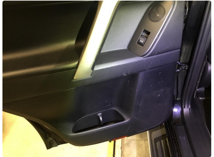
1.1 Noe riper/bruksslitasje dørtrekk v.bakdør og bakdør.
