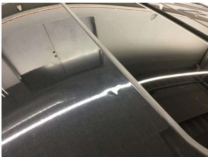
1.5 2 svake bulker uten lakkskade framkant tak.
