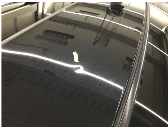
1.5 2 svake bulker uten lakkskade framkant tak.
