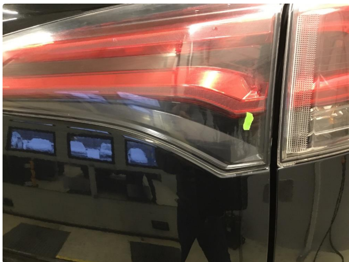
2.1 Noe skjolder innvendig baklamper begge sider.
