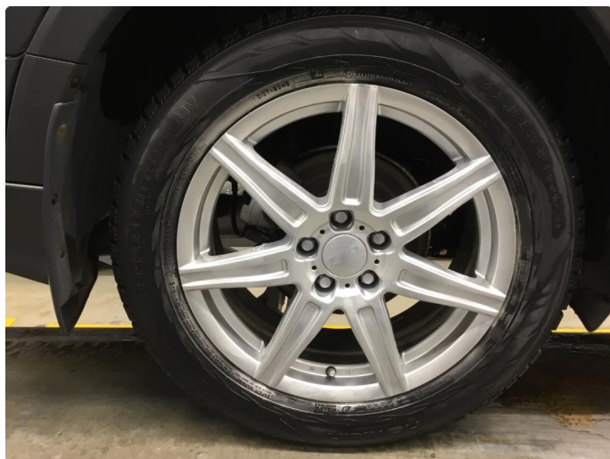
1.4 Oksidering alle 4 vinterfelger, er sprayet over.
