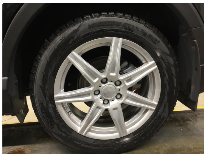
1.4 Oksidering alle 4 vinterfelger, er sprayet over.
