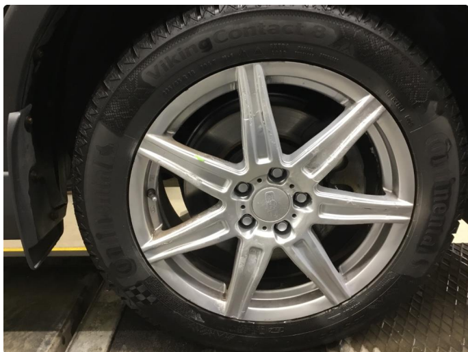
1.4 Oksidering alle 4 vinterfelger, er sprayet over.
