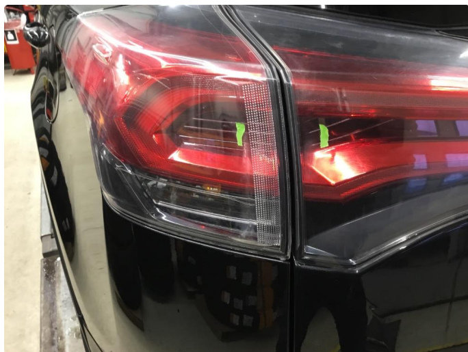
2.1 Noe skjolder innvendig baklamper begge sider.
