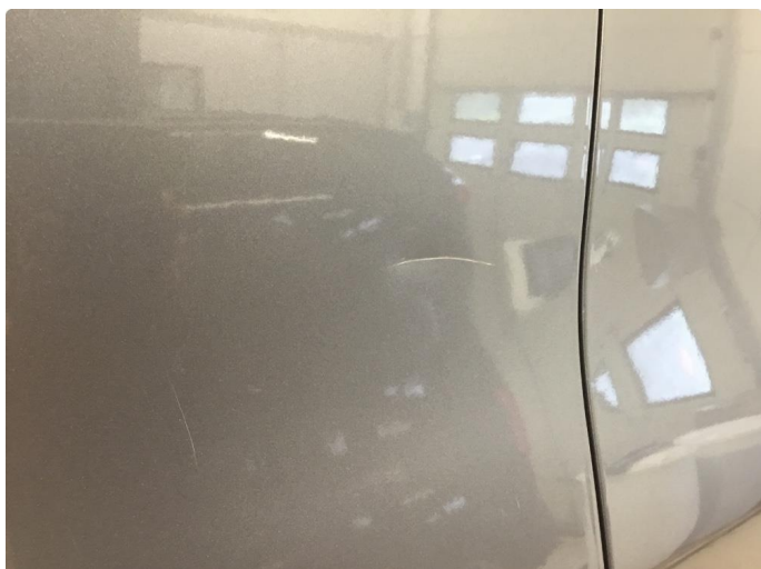
1.1 Bulk med lakkskade
