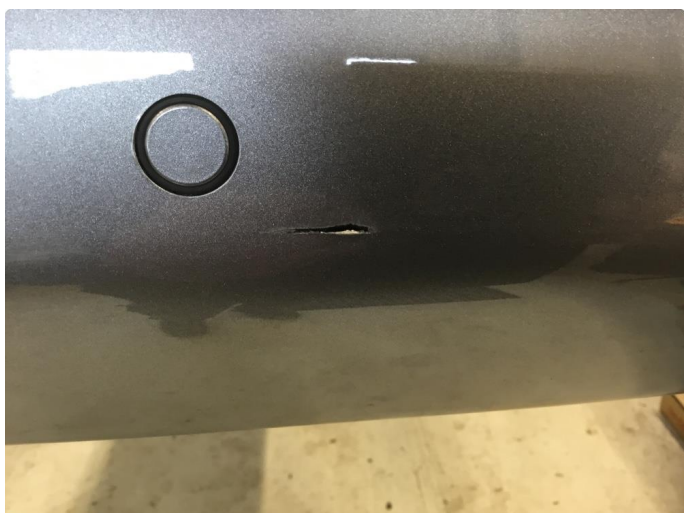
1.2 Bulk med lakkskade
