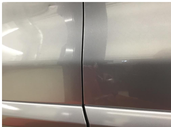
1.1 Bulk med lakkskade
