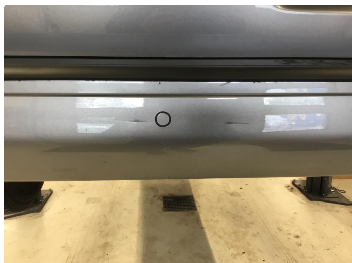
1.2 Bulk med lakkskade
