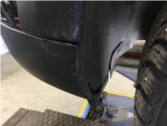
1.2 Sprekk i framkant plastinnerskjerm venstre foran. Bruksslitasje.
