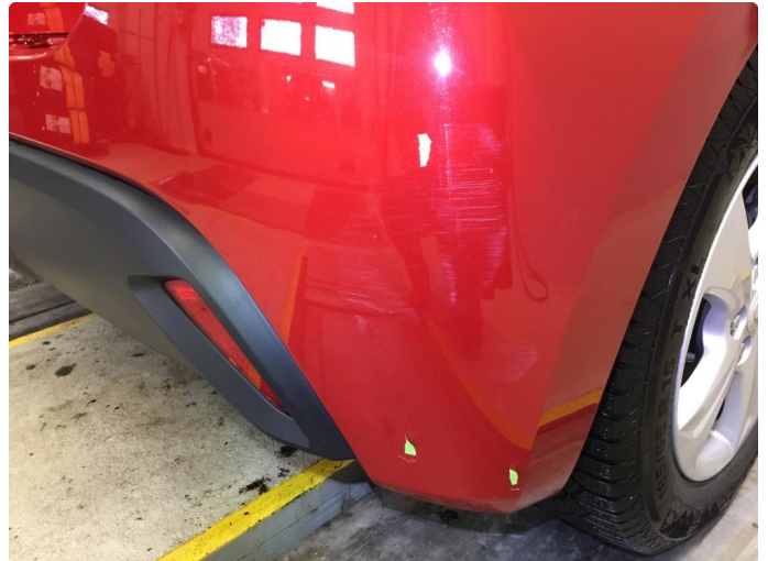
1.2 Noen hakk i lakken og subbeskade/riper h.fangerhjørne bak. Rubbes/flekkes klargjøring.
