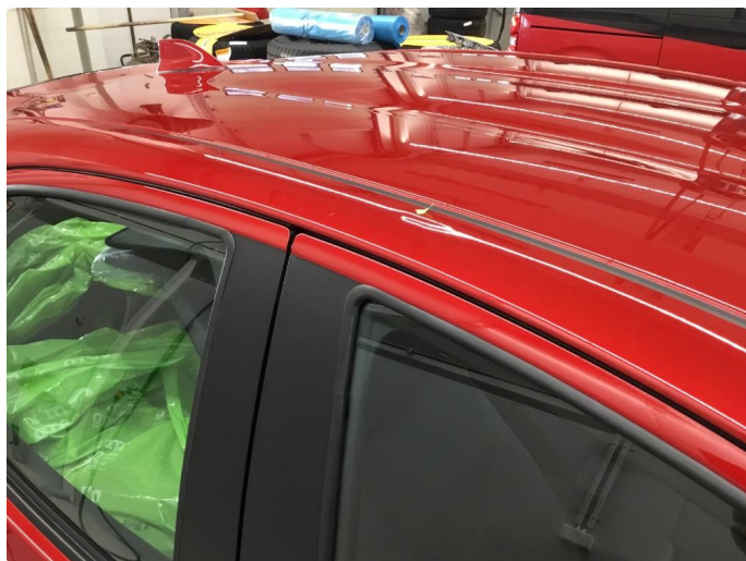
1.3 Bulk h.takvange over bakkant fordør. Smartrep.
