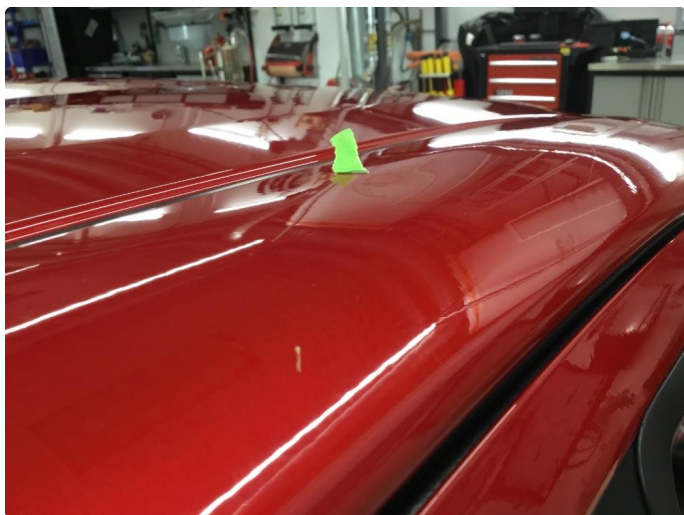
1.3 Bulk h.takvange over bakkant fordør. Smartrep.
