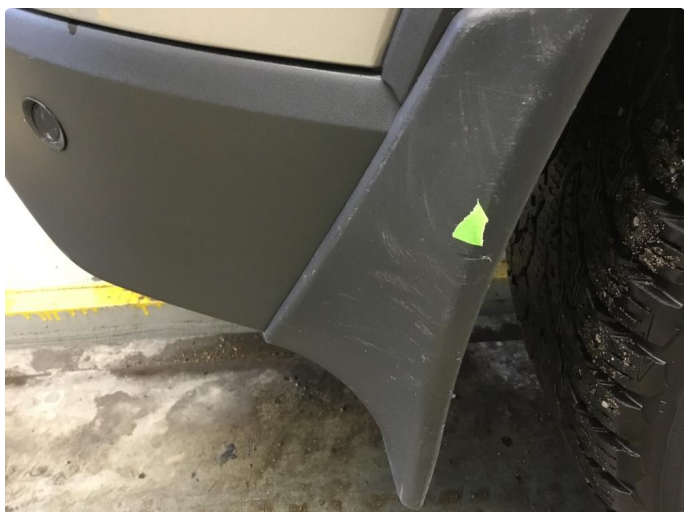
1.2 Lite hakk i skvettlapp h.bak. Normal bruksslitasje.
