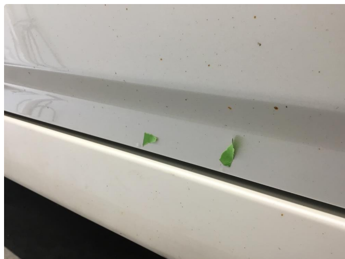
1.2 Liten p-bulk midt på h.fordør, samt 2 bobler i lakken nedkant. Normal bruksslitasje utifrå år/km.
