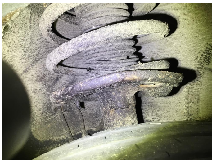
2.1 Støvmansjetter revnet på støtdempere foran begge sider.(ikke mangel PKK)
