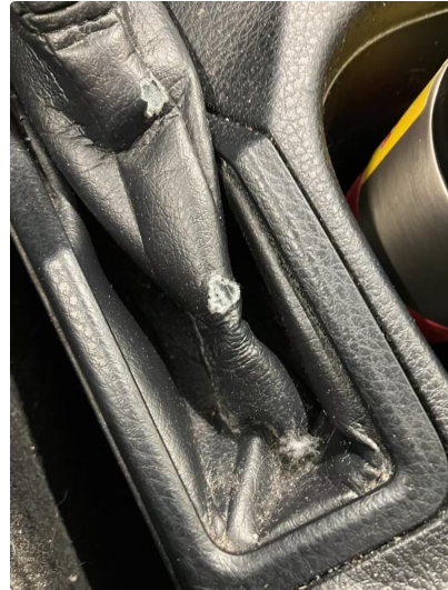
3.1 Noe slitt tekk rundt håndbrekkstang.
