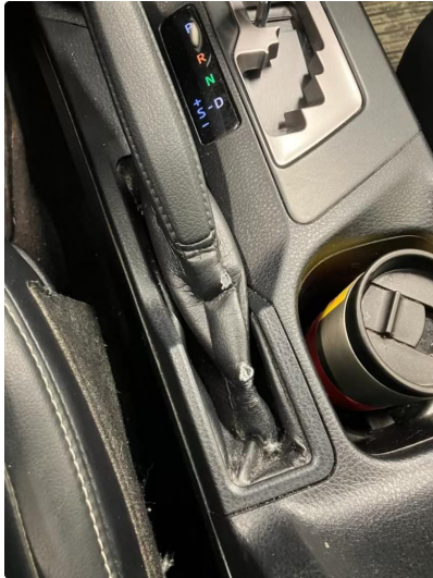
3.1 Noe slitt tekk rundt håndbrekkstang.
