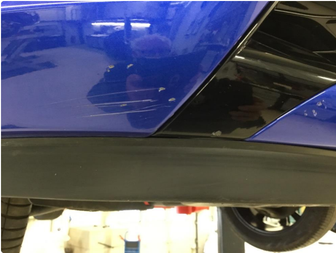
1.1 Liten skrubbskade underkant av frontfanger plast.
