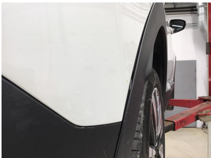
1.1 Skjermutbygger h.bak løs. Ny er bestilt Eta. 30.11-24
