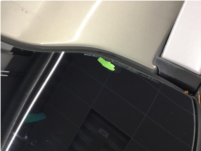
1.2 Noe lamineringsslipp frontrute. Normal bruksslitasje.
