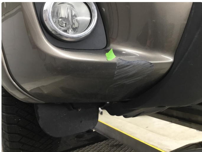
1.5 Skrapeskade høyre hjørne fanger/skjermbredder foran.
