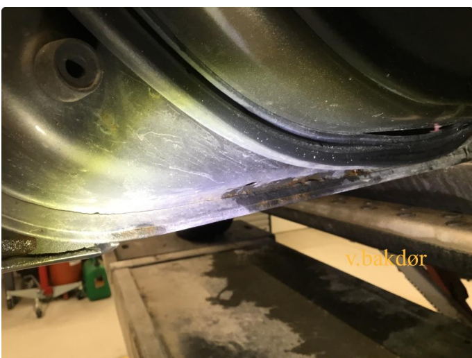
1.3 Noe rust i fals v.fordør og begge bakdører.
