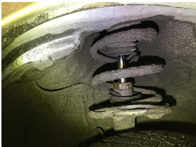
3.1 Støvmansjett støtdempere begge sider foran revnet. Ikke påkrevd.
