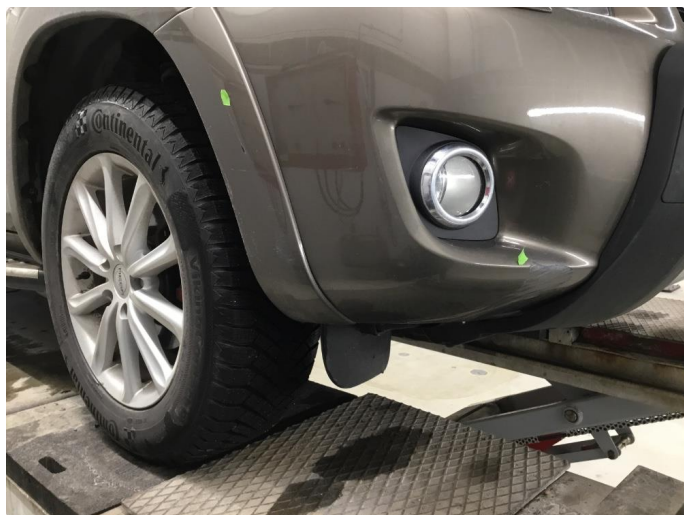
1.5 Skrapeskade høyre hjørne fanger/skjermbredder foran.
