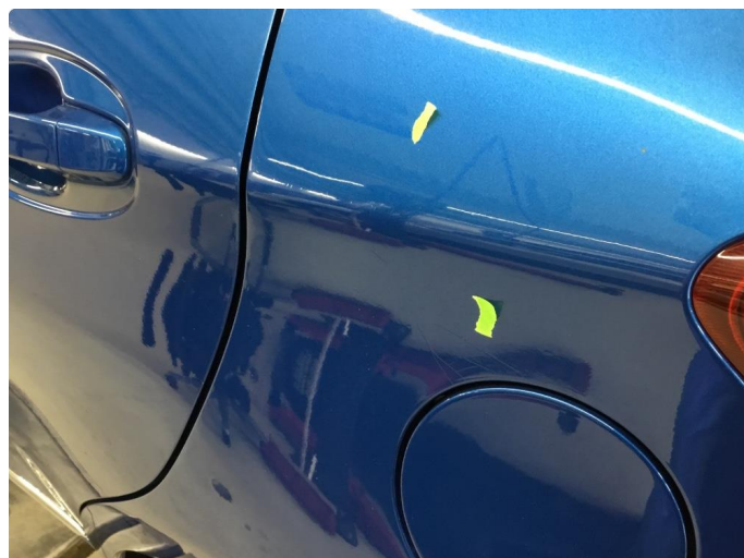
1.2 Noe riper/krakilering under lakk v.bakskjerm.
