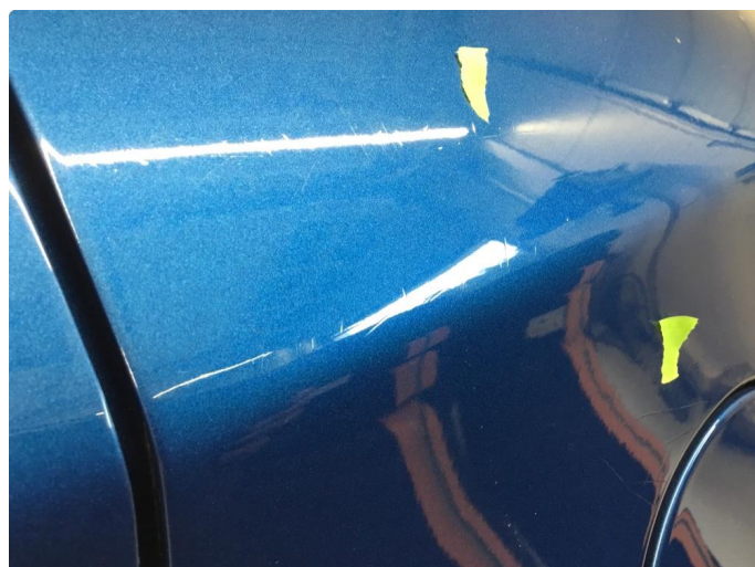
1.2 Noe riper/krakilering under lakk v.bakskjerm.
