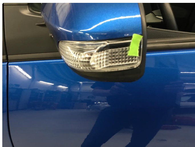
2.1 Litt krakilering i kanten på blinklampe v.speil.
