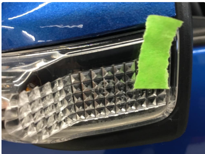
2.1 Litt krakilering i kanten på blinklampe v.speil.
