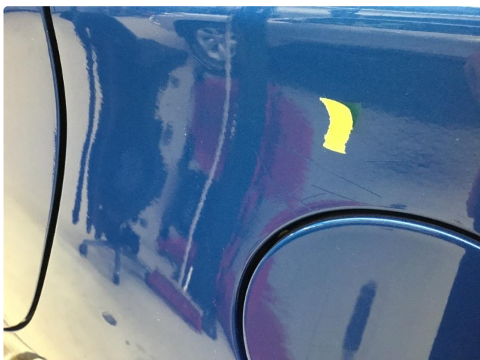
1.2 Noe riper/krakilering under lakk v.bakskjerm.
