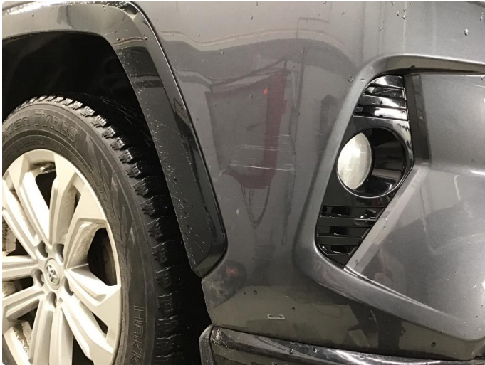
1.1 Liten subbeskade i frontfanger H side
