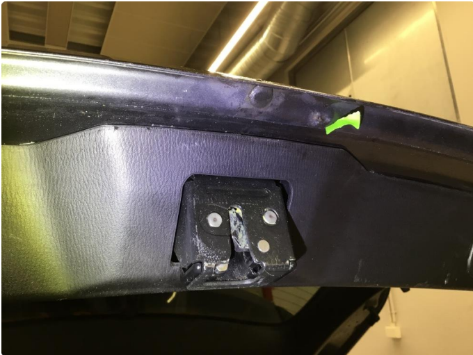
1.2 Liten rustblemme i lakk innv. nedkant bakluke.
