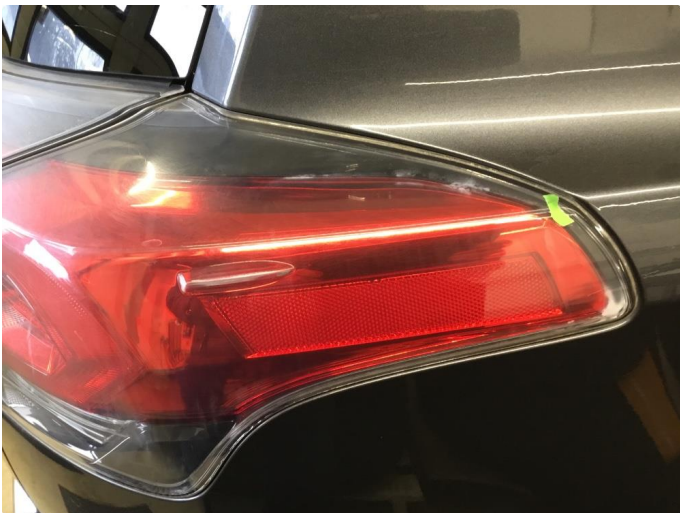
2.1 Skjolder/Hvit belegg innvendig alle 4 baklamper, Har ingen betydning på funksjon.
